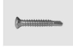
Vis autoperceuse 3,9x19 mm pour la fixation de : • Structure support en alu avec Clips pour plots de terrasse • Raccordement longitudinal • Raidisseur transversal
