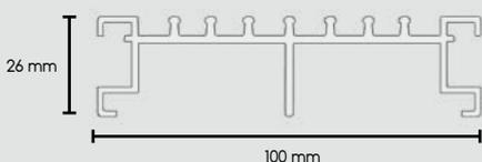
Aufbauhöhe inkl. Montageklammer und 3 Stück Unterlegplatten max. 41 mm
