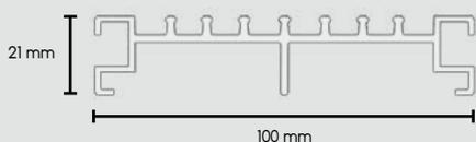
Aufbauhöhe inkl. Montageklammer und 3 Stück Unterlegplatten max. 31 mm
