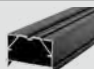
BIG-Isostep (Alu) 54 Terrassenlager Abstand Auflagepunkte max. 110 cm
