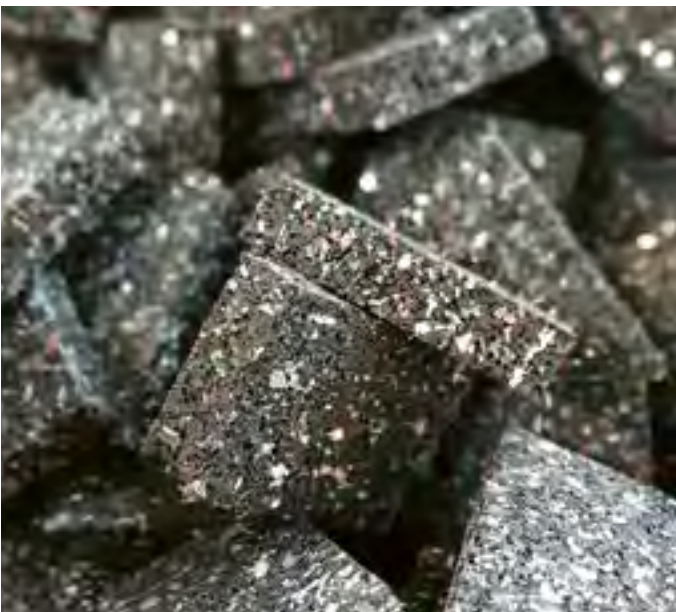
Isopads aus 95 % Altreifengranulat
